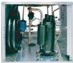
Двойная пружина и изолирующая шайба компрессора
